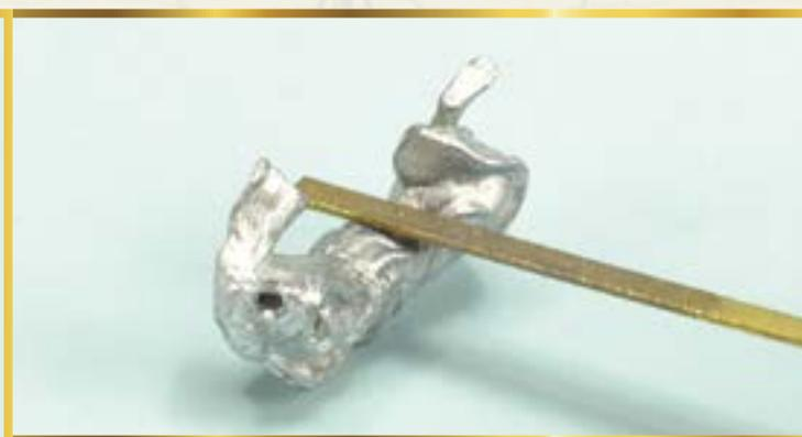
**1** В этом выпуске мы продолжим работать над декоративными элементами носовой части модели. Возьмите пять деталей фигурки С92, которые прилагаются к данному выпуску, и с помощью надфиля и наждачной бумаги избавьтесь от возможных заусенцев и небольших дефектов.
